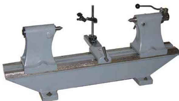
Art. S224 – Apparecchio a due punte per il controllo della concentricità, in ghisa stabilizzata con superfici scorrimento rettificate Dotate di supporto porta comparatore. Bench center, base and tailstock from case iron height of center point 176 mm , for dial indicator with shank 8 mm
