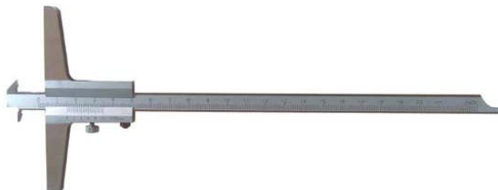
Art. C060 – Calibro profondità 1/20=0,05 DIN 862 doppio uso Depth vernier caliper DIN 862 nonius 1/20=0,05 rod convertible
